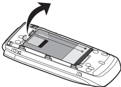
Um den SIM-Kartenhalter zu öffnen, drücken Sie leicht darauf (1) und heben den Halter an (2).
