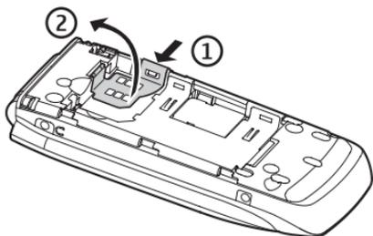
Setzen Sie die SIM-Karte ordnungsgemäß in den Halter ein.
