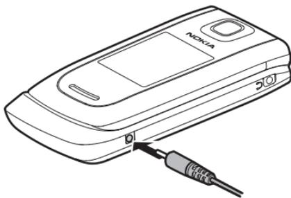
Ist der Akku vollständig entladen, dauert es möglicherweise einige Minuten, bis die Ladeanzeige in der Anzeige eingeblendet wird oder Sie Anrufe tätigen können.
